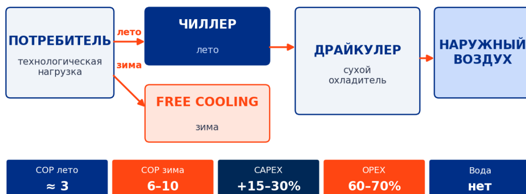
Схема 2 — чиллер с режимом Free Cooling (свободное охлаждение в холодный период).
