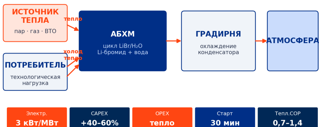
Схема 5 — АБХМ (абсорбционная бромисто-литиевая холодильная машина) с источником тепла и градирней-охладителем.
