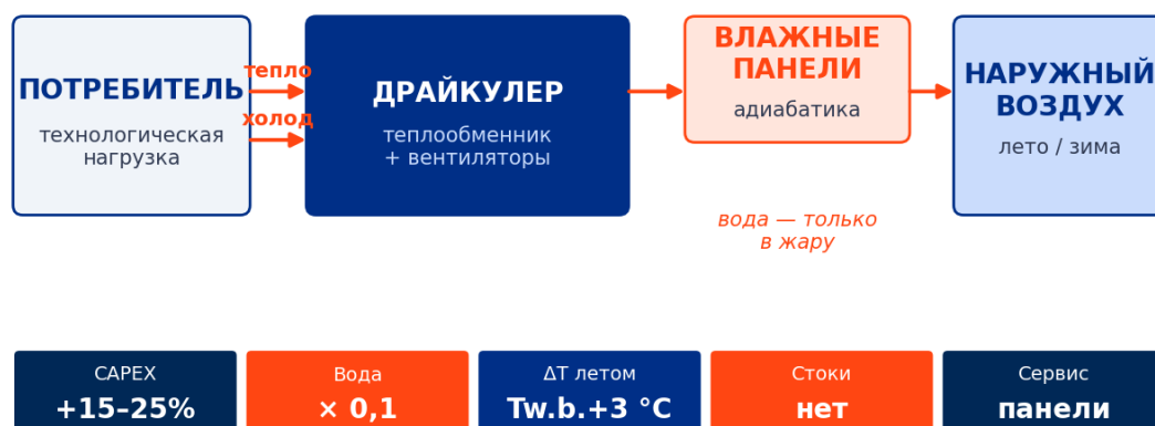
Схема 6 — драйкулер с панелями адиабатического увлажнения (минимум воды).
