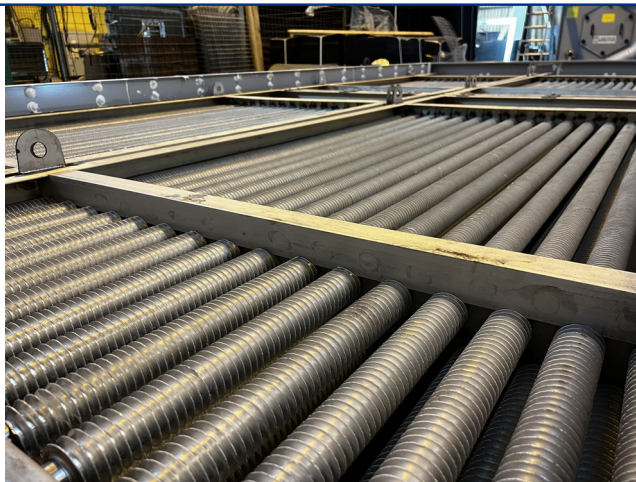
Оребрённые трубы в производстве — основа теплообменников драйкулеров и закрытых градирен НСТ
