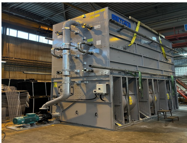
Закрытая градирня большой мощности на сборке. Завод НСТ, Сертолово
