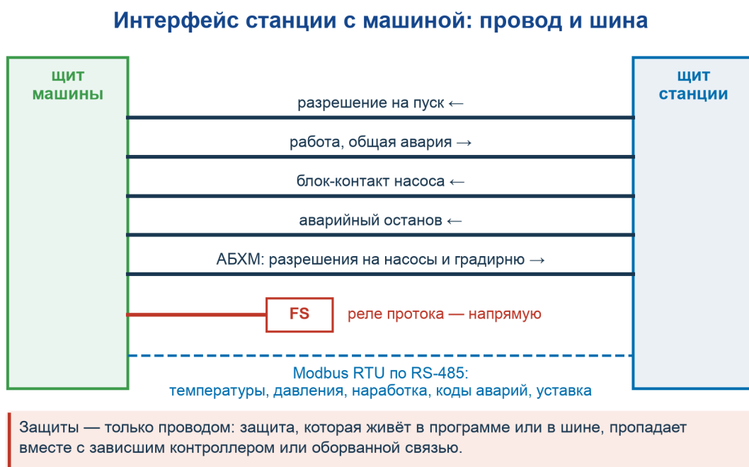
Рисунок 2 Интерфейс станции с машиной: провод — для того, что должно сработать всегда, шина — для того, что полезно знать
