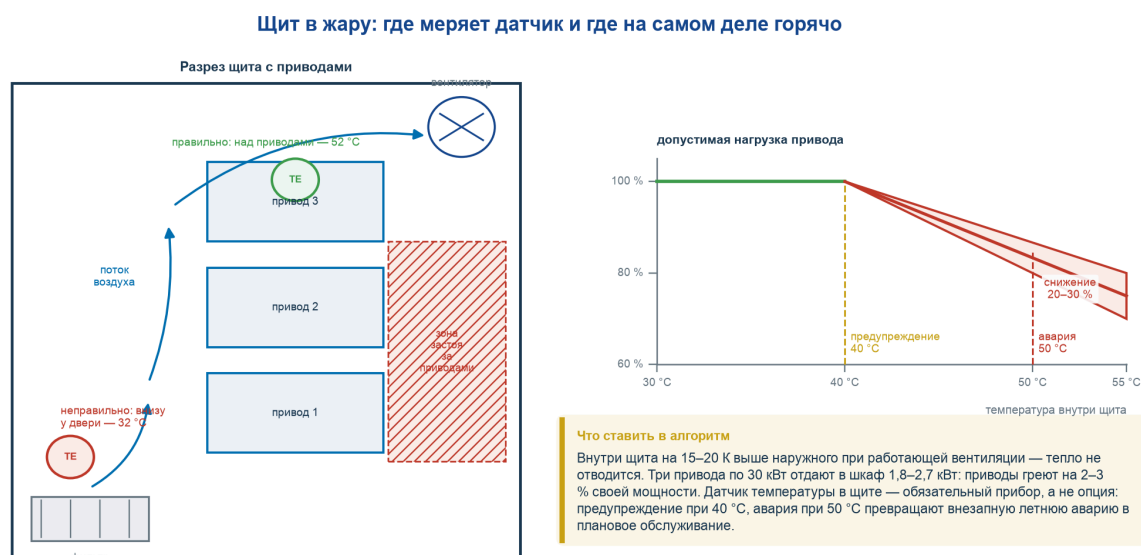
Рисунок 37 Щит в жару: датчик у двери показывает 32 °С, над приводами уже 52 °С
