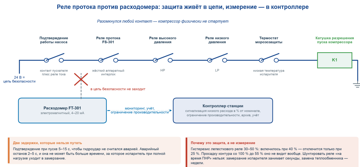
Рисунок 10 Реле протока — в цепи безопасности машины, расходомер — в контроллере станции
