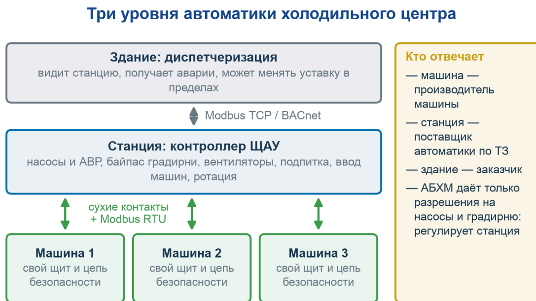
Рисунок 5 Master-щит в системе: машины со своими щитами внизу, станция в середине, диспетчеризация сверху
