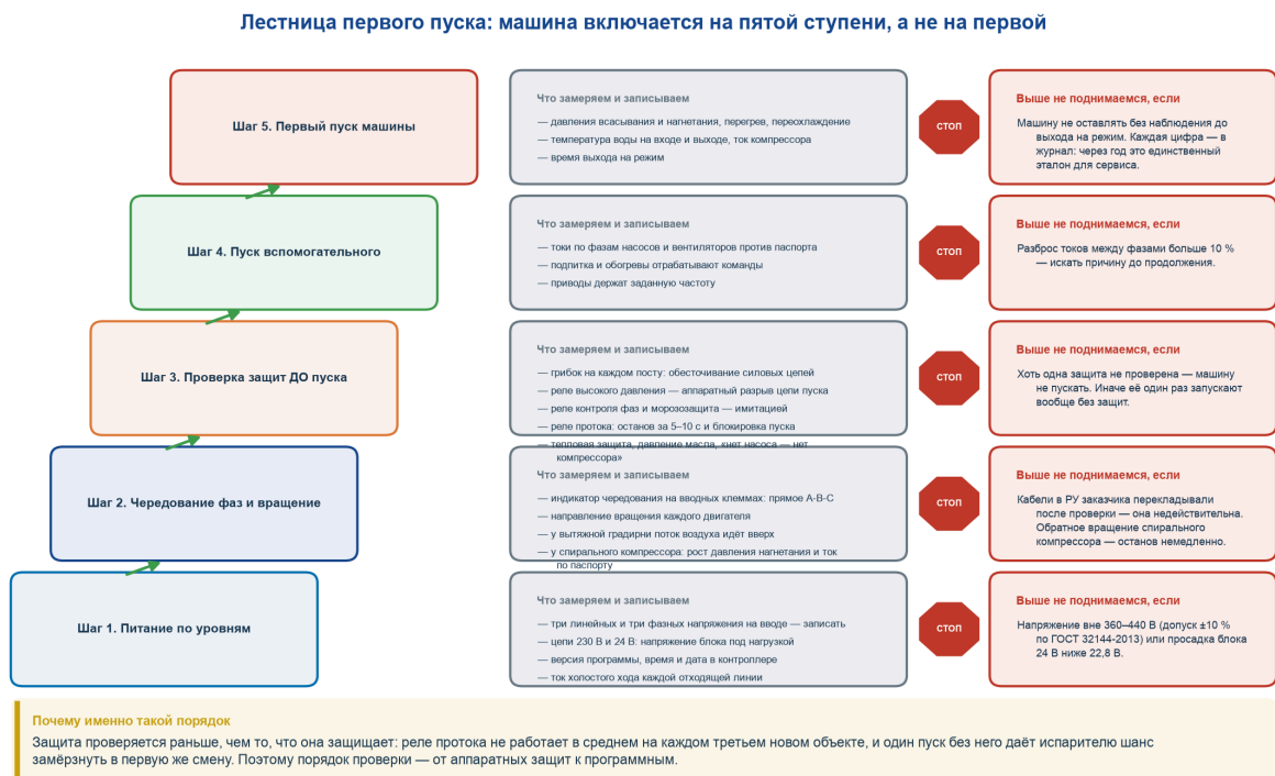
Рисунок 32 Лестница первого пуска: на каждой ступени замеры и условие, при котором выше не поднимаются
