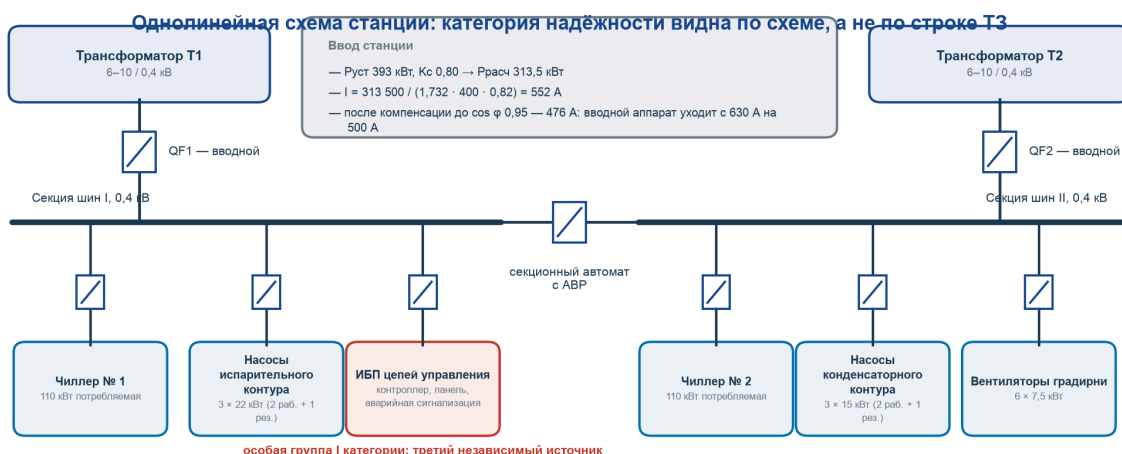
Рисунок 28 Однолинейная схема станции: две секции шин с АВР, цепи управления от ИБП отдельной группой
