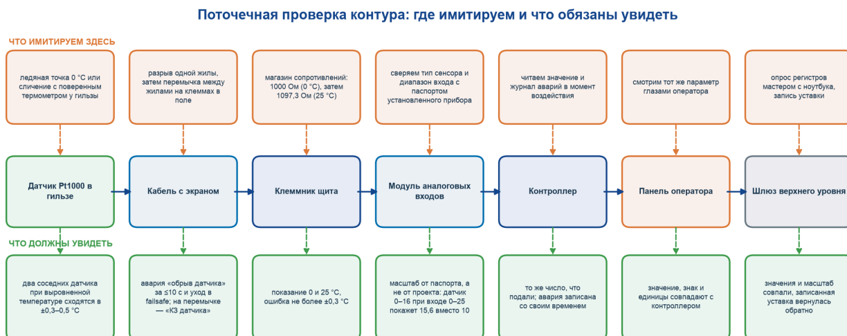
Рисунок 31 Цепочка одного сигнала: имитация доказывает целостность только правее точки воздействия
