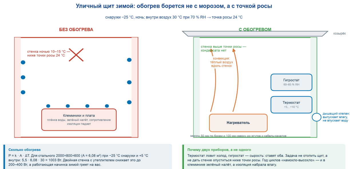
Рисунок 17 Обогрев уличного щита борется не с морозом, а с точкой росы
