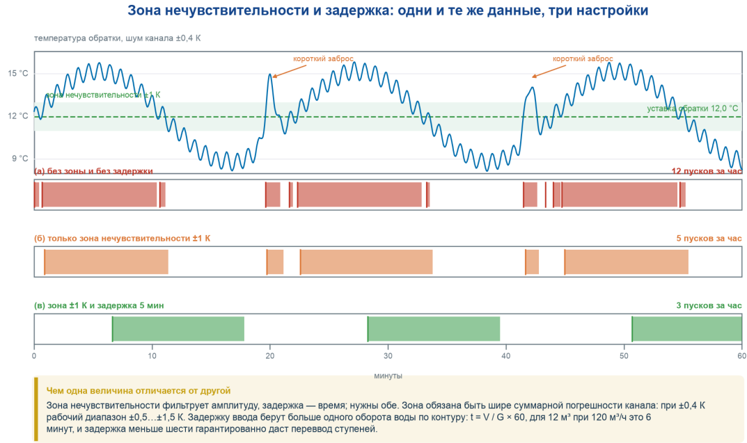
Рисунок 18 Одни и те же данные при трёх настройках: зона убирает шум, задержка убирает переходные процессы, вместе — три пуска вместо двенадцати
