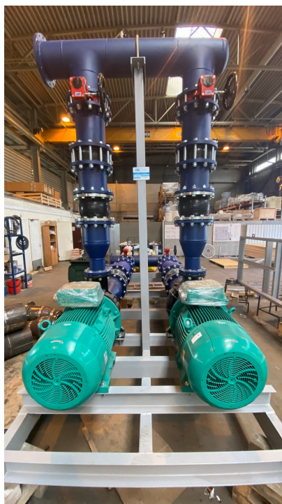
Рисунок 4 Заводская насосная группа NCT на раме перед отгрузкой: два насоса, коллекторы, затворы и гибкие вставки собраны и испытаны на заводе
