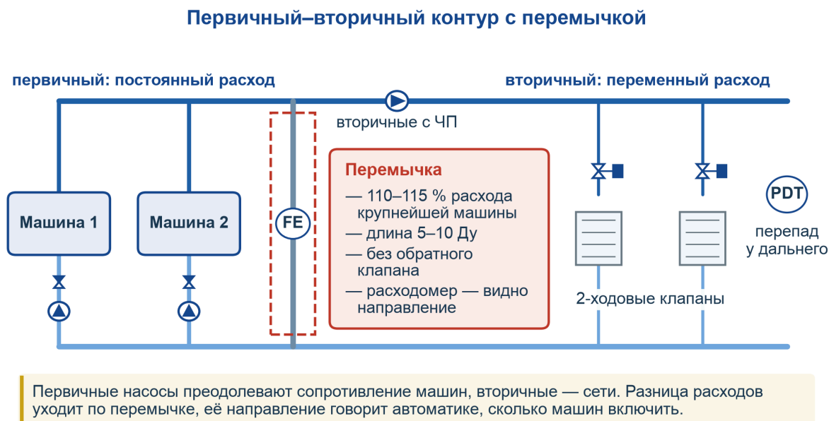
Рисунок 21 Первичный–вторичный контур: перемычка забирает разницу расходов, её направление говорит автоматике, сколько машин включить
