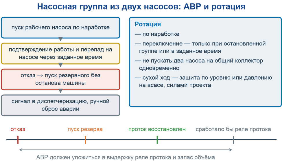
Рисунок 36 АВР и ротация насосной группы: резерв должен восстановить поток раньше, чем работает реле протока машины
