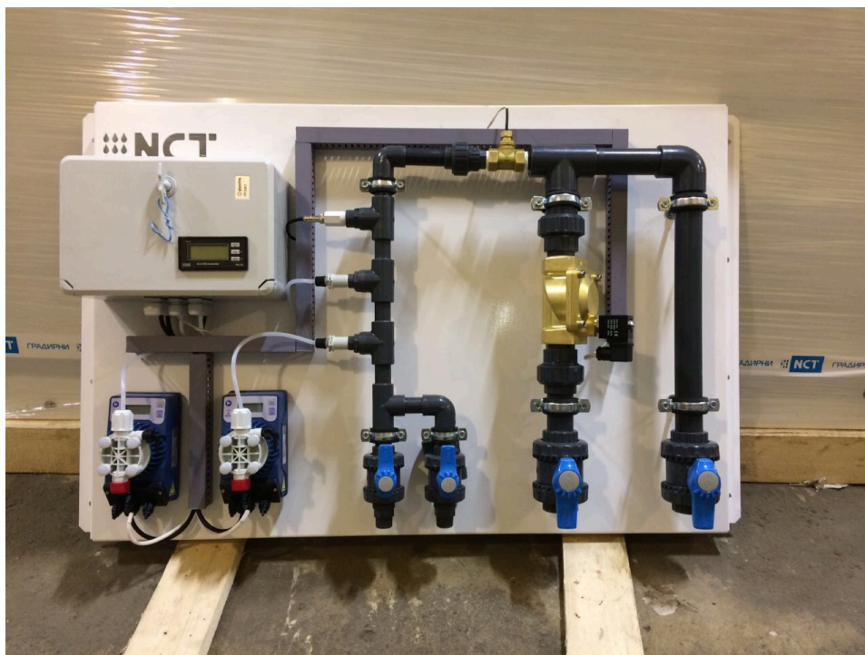
Рисунок 9 Панель ХВП NCT исполнения W2C: контроллер проводимости, два дозирующих насоса, клапан продувки
