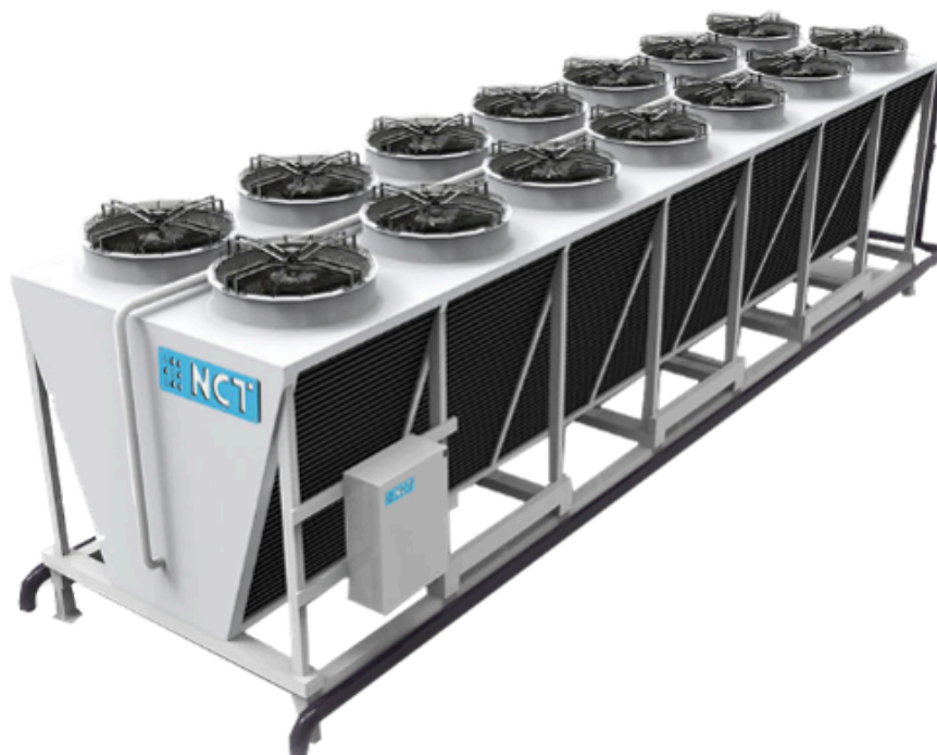
Рисунок 1 Драйкулер NCT серии DC: V-образный теплообменник, ряд осевых вентиляторов сверху, щит на раме
