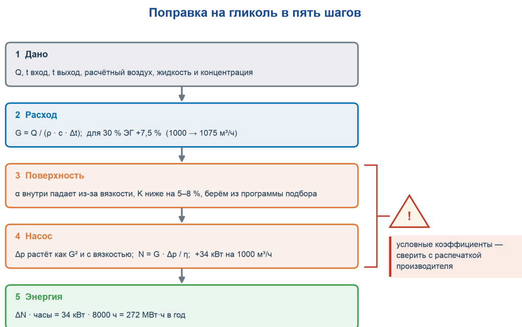
Рисунок 12 Поправка на гликоль в пять шагов: расход, поверхность, насос, затраты на перекачку
