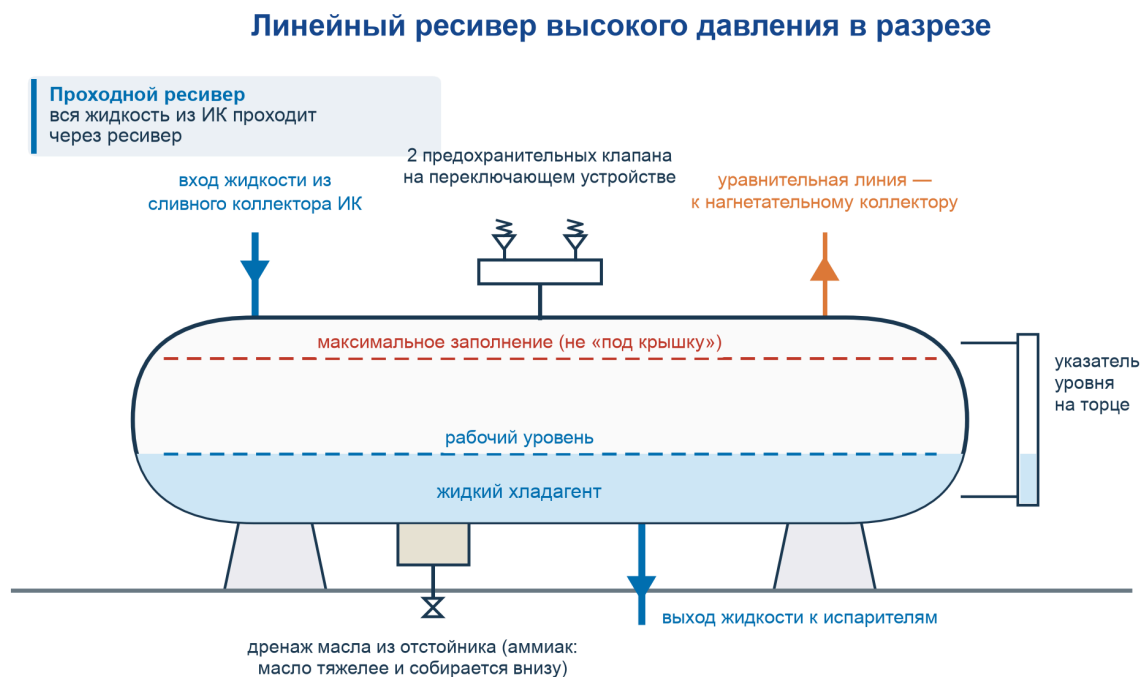
Рисунок 27 Линейный ресивер высокого давления: вход из сливного коллектора, уравнительная линия к нагнетательному коллектору, указатель уровня, максимальное заполнение не «под крышку»
