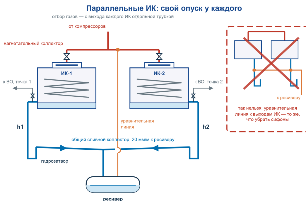
Рисунок 21 Параллельные ИК: свой опуск с гидрозатвором у каждого, уравнильная линия — в нагнетательный коллектор
