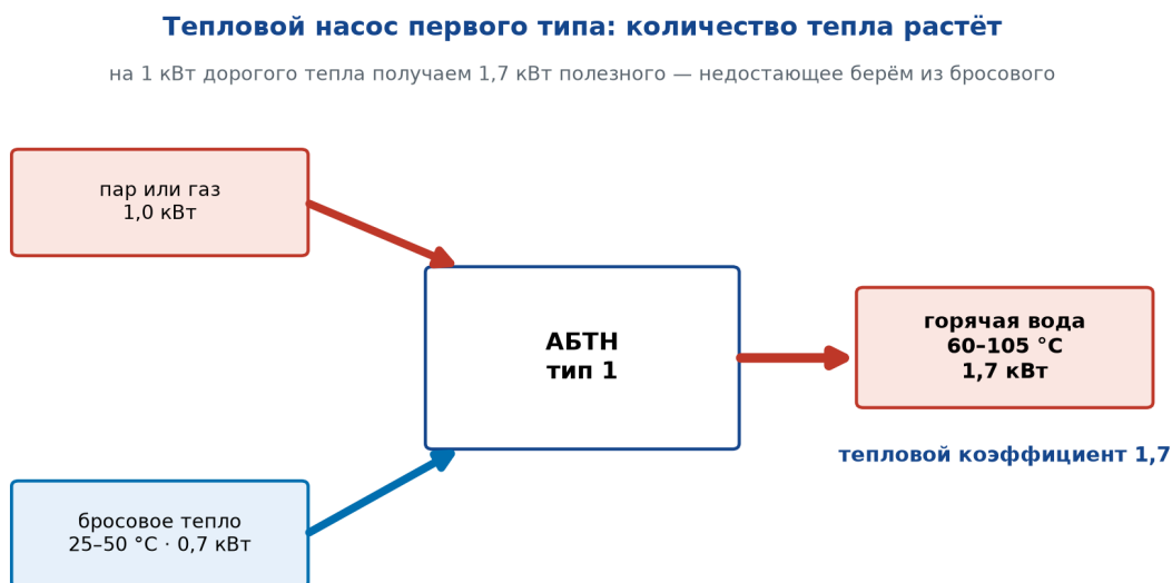
Рисунок 1 Тепловой насос первого типа: 1 кВт дорогого тепла и 0,7 кВт бросового дают 1,7 кВт горячей воды
