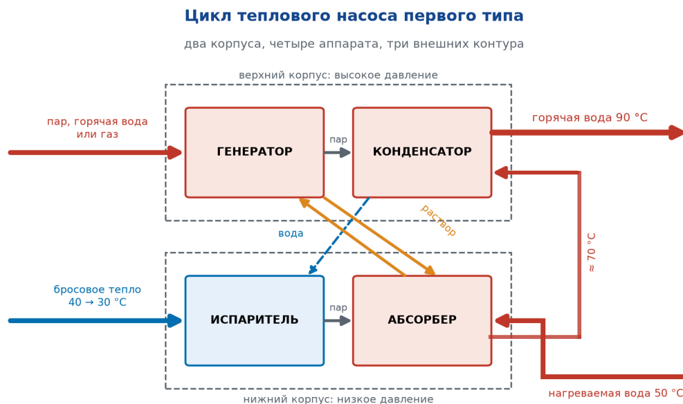
Рисунок 4 Цикл теплового насоса первого типа: бросовое тепло входит в испаритель, нагреваемая вода проходит абсорбер и конденсатор
