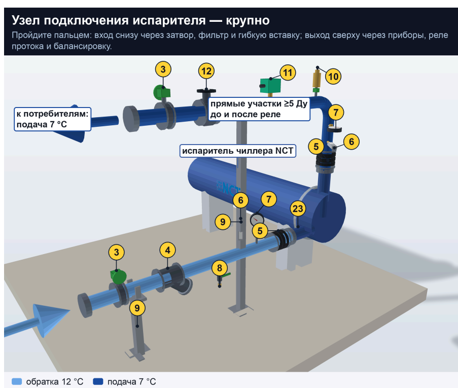
Рисунок 26 Узел подключения испарителя чиллера NCT: обратка 12 °С входит снизу, подача 7 °С уходит сверху
