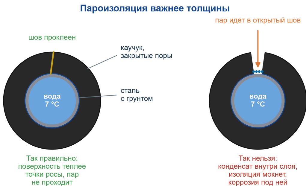
Рисунок 31 Непроклеенный шов превращает изоляцию в губку: пар проходит к холодной стенке и конденсируется внутри
