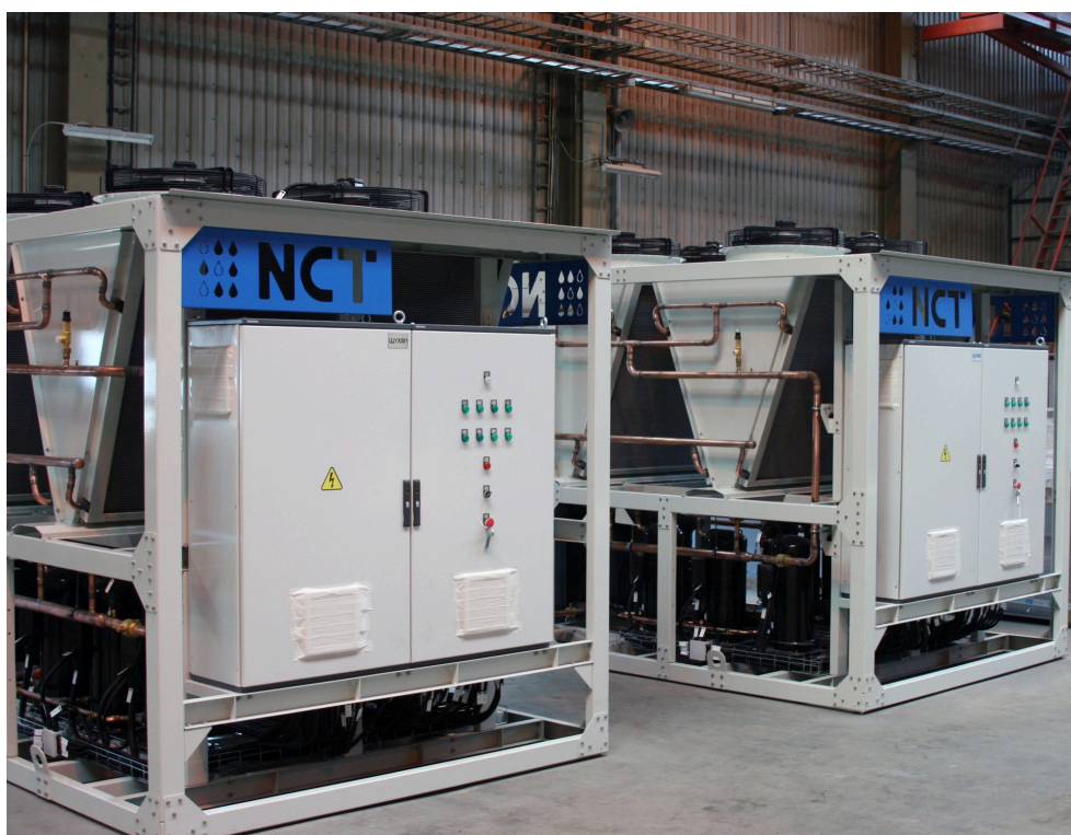
Рисунок 5 Моноблоки NCT на заводе перед отгрузкой: щит управления на торце, конденсаторы сверху
