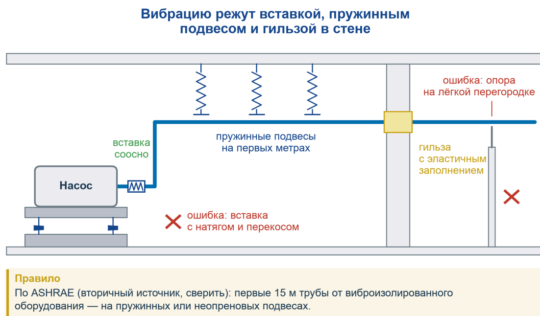
Рисунок 32 Вибрацию режут три раза: вставкой у насоса, пружинным подвесом рядом и гильзой в стене
