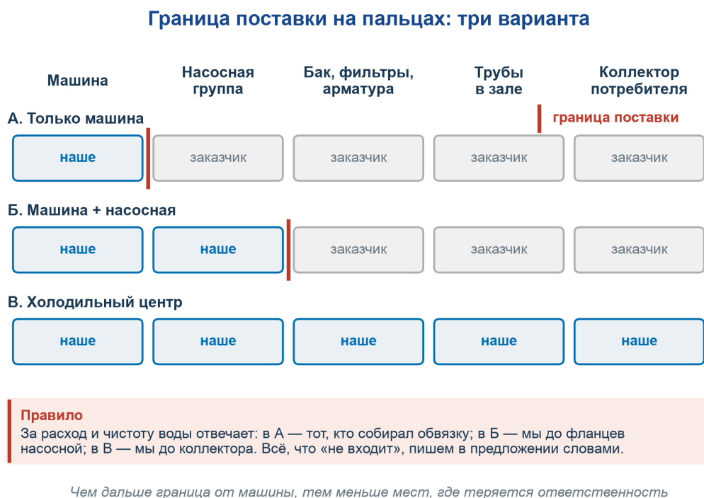
Рисунок 7 Граница поставки: только машина, машина с насосной группой, холодильный центр
