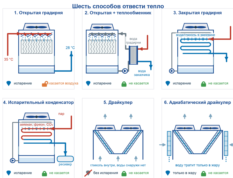
Рисунок 1 Шесть способов отвести тепло: где есть испарение и где вода заказчика касается воздуха
