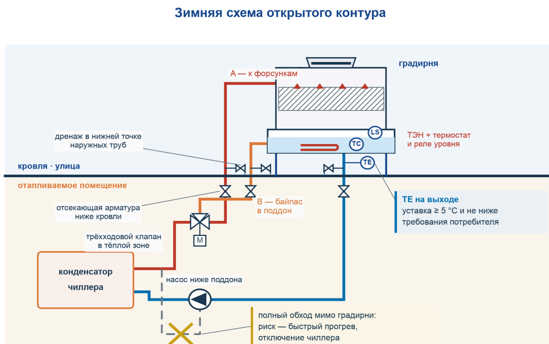
Рисунок 30 Зимняя схема открытого контура: трёхходовой клапан в тёплой зоне, байпас в поддон, ТЭН, дренажи наружных труб
