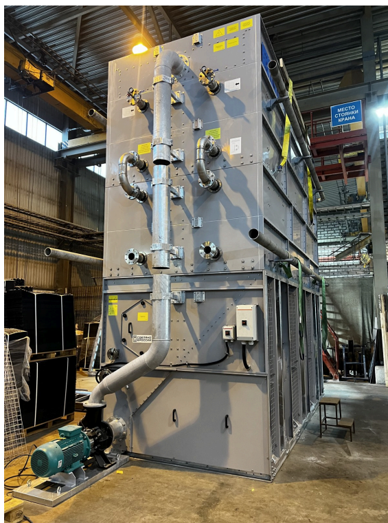
Рисунок 6 Закрытая градирня NCT с оребрённым змеевиком на заводе перед отгрузкой: патрубки змеевика и насос орошения
