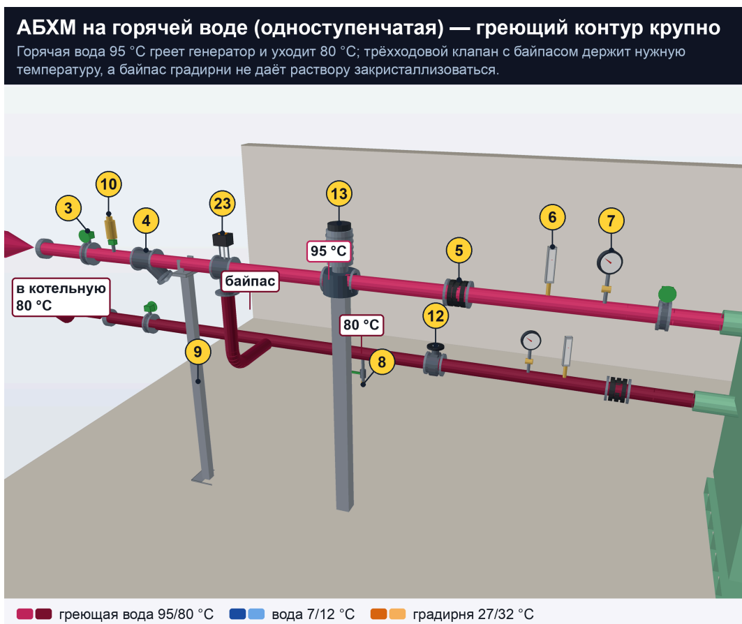
Рисунок 13 Греющий контур крупно: трёхходовой клапан стоит на подаче, до насоса машины
