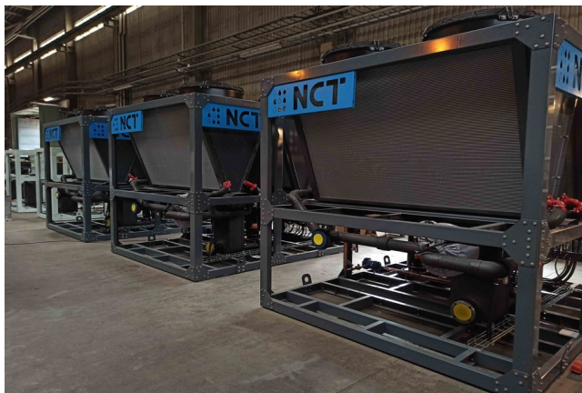
Холодильные машины NCT в сборе со шкафами автоматики — модульное исполнение, готовое к подключению на объекте.
