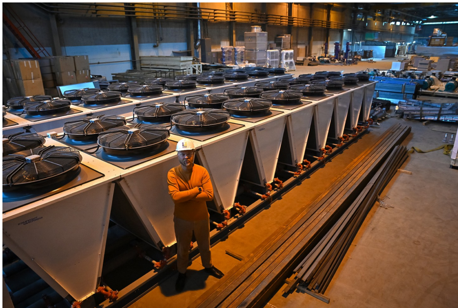
Производство NCT — Санкт-Петербург. Холодильное оборудование собирается и испытывается на заводе до отгрузки.
